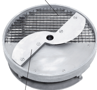
obrotowy element z nożem odcinającym
