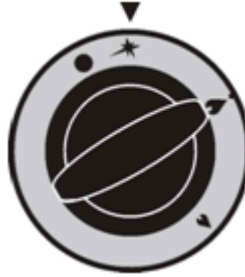
Rysunek 3. Położenie pokrętła około 30^{\circ} podczas zapalania palnika.
